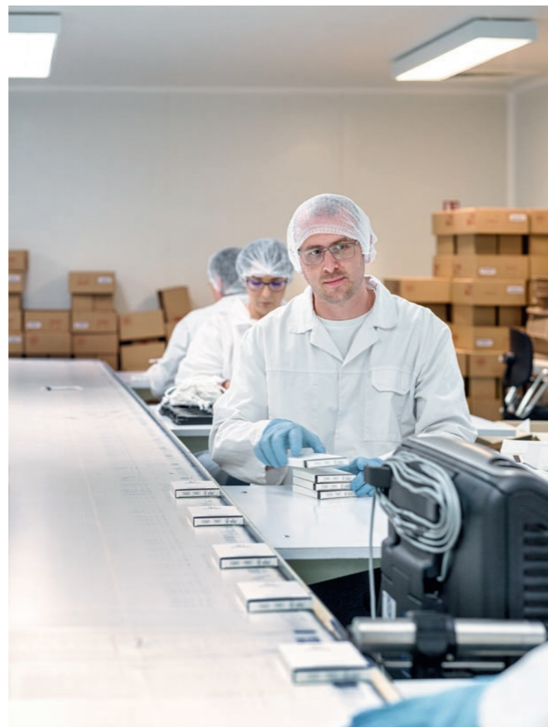
Jeremy passe à l'imprimante laser des produits de beauté afin de marquer la traçabilité sur les étuis. Derrière se trouve Wahiba, opératrice de production.
